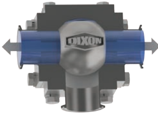
3-vías puerto 'T' posición A
