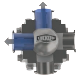
4-vías puerto 'L' posición D
